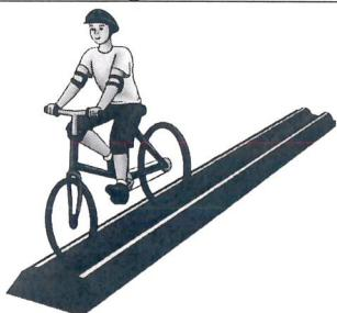
Препятствие длиной 3 м., высотой 5 см., склошенное со стороны въезда и выезда для плавности начала и конца преодоления препятствия. По краям доски в длину прикреплены рейки высотой 3,5 см. так чтобы ширина углубления была 10 см., тем самым образуя желоб.
