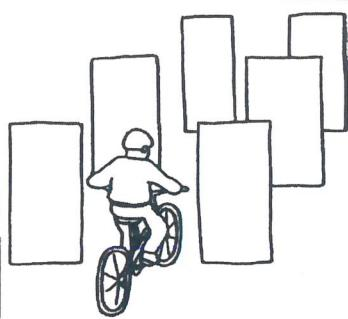
Используются стойки на утяжеленном основании, выстой 1,7 м. На стойки одеваются щиты высотой 1,2 м так, чтобы от нижнего края щита до земли было не менее 80 см. Щиты свободно вращаются на стойке. Одна сторона белая, на другой чередование наклонных белых и красных полос шириной 15 см. Ширина на 12 см шире велосипеда, предоставляемого организаторами. Необходимо 8 стоек, образующих 4 пары узких проездов, расположенных друг от друга на расстоянии не более 1 м.
