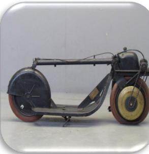
*1915 год: США (автопед) с крошечными колесами, платформой-подножкой, складным рулем*
